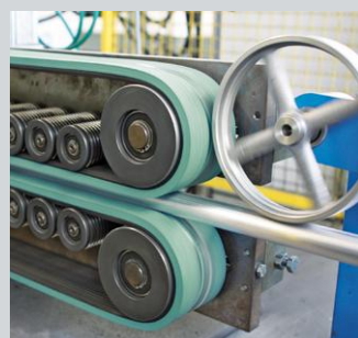
„Caterpillar“ unit for composite pipes
